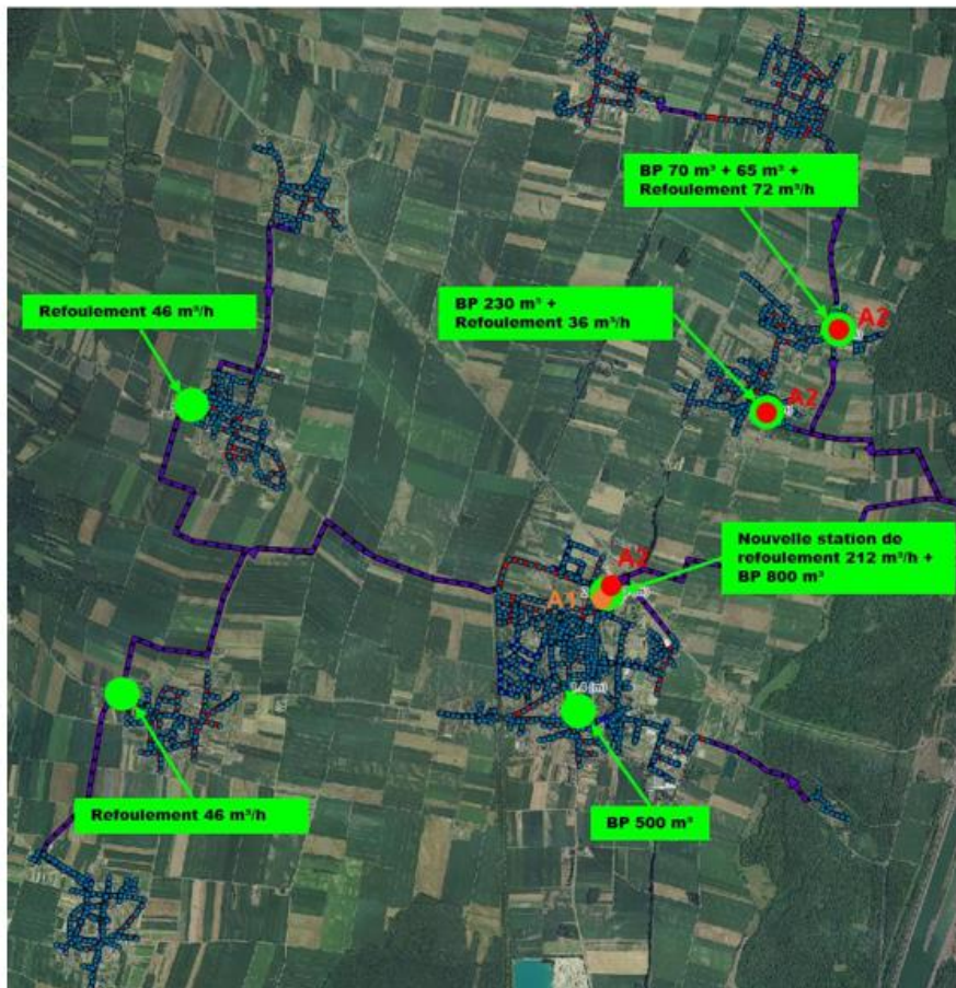
Figure 5 : Programme de travaux – schéma directeur assainissement
