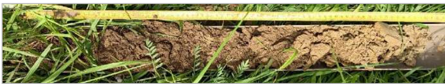
Photo 29 : Profil pédologique d'un FLUVIOSOL à horizon rédoxique accessoire de profondeur et à texture limoneuse (Sondage P3). Photo prise sur site, © Rainette, 2024.
